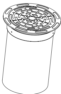
Teleskopická šachta pro potrubí 425 třídy D400
