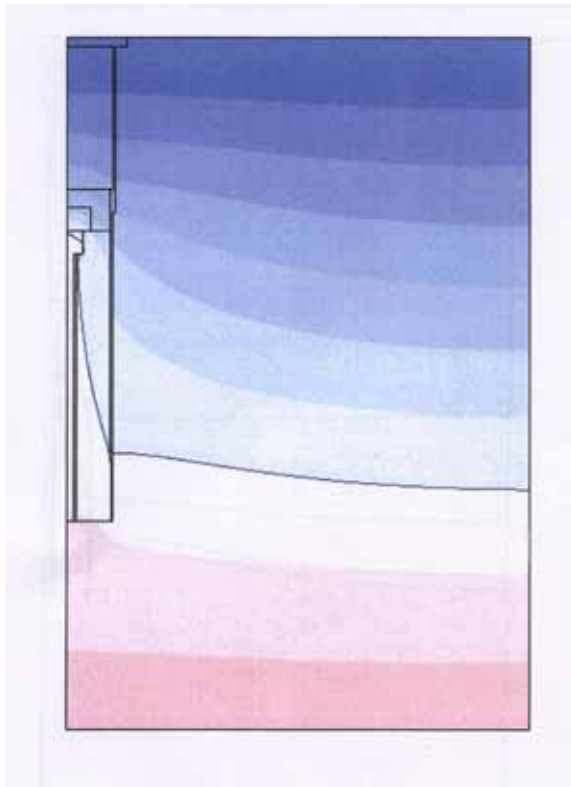
Obr. 4.a. Izotermny: čas nezbytný k zamrznutí šachty (29,2 dní)
